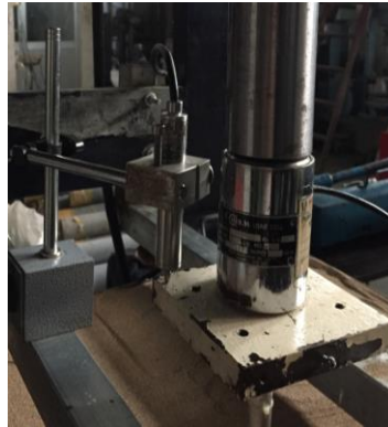
Hình 3. 5: Quá trình hạ cọc – Kiểm tra độ thẳng đứng và tiến hành ép
