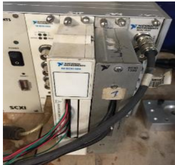
Hình 3. 7: Bộ xử lý tín hiệu kết nối đầu đọc gia tốc và đầu đo
