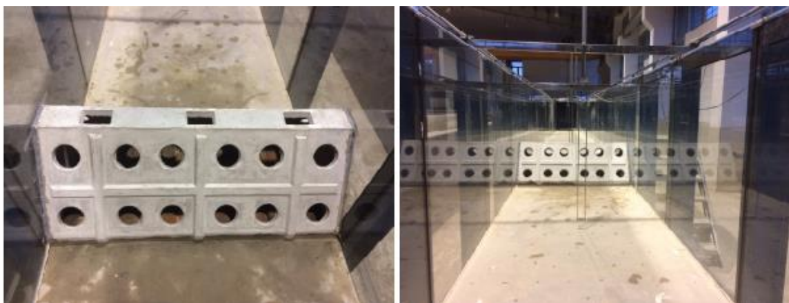
Hình 3. Thiết lập thí nghiệm truyền sóng qua đê giảm sóng kết cấu rỗng
