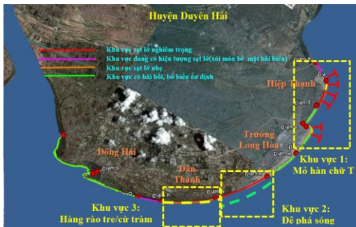
Hình 3. 16: Sơ đồ định hướng bố trí công trình chính trị
