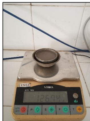
Hình 7: Cân khối lượng mẫu trước thí nghiệm (TTN), sau bão hòa (BH) và sau khi thí nghiệm (STN) (Trong hình: mẫu đất (Đ) + dao vòng (DV) + chén nhôm (CN) )
