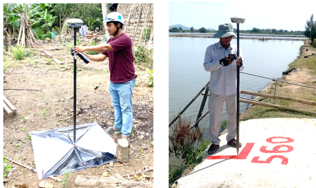
Hình 4. Điểm GCP trên thực địa và đo RTK
