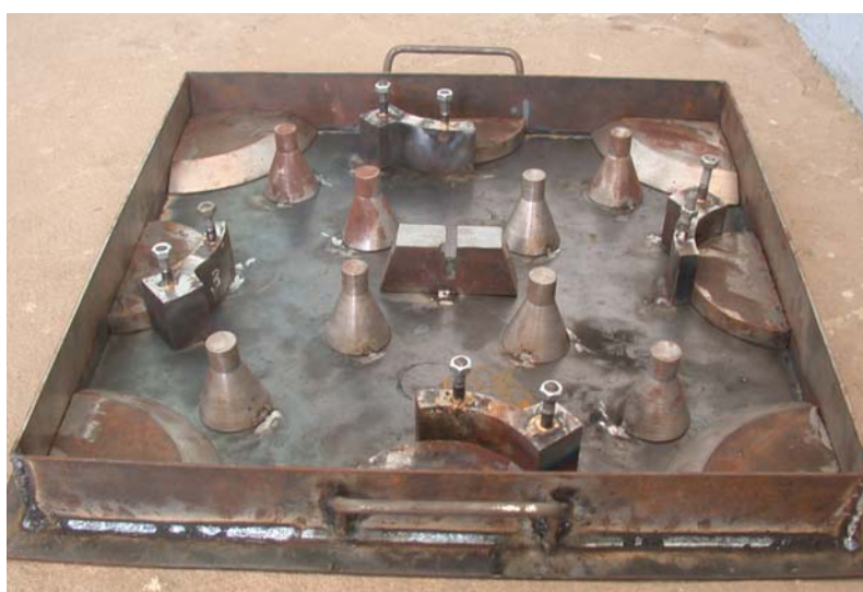
Hình 11: Khuôn đúc tấm bê tông
