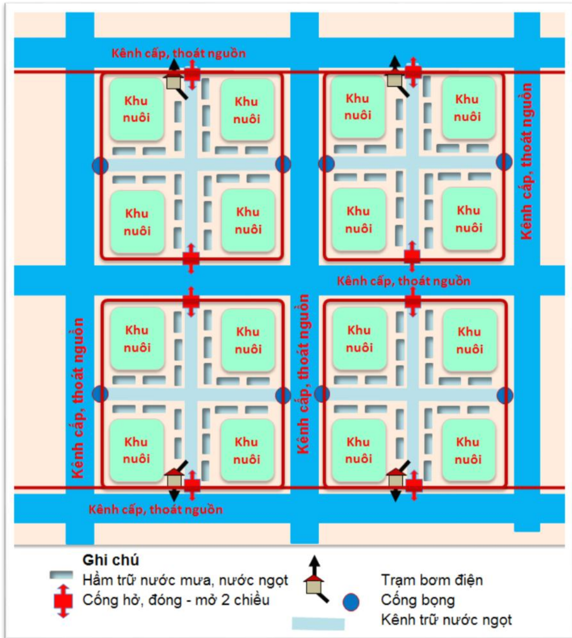
Hình 19. Sơ đồ mặt bằng bố trí HTTL nội đồng vùng luân canh tôm - lúa không có nguồn tiếp ngọt
